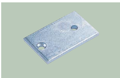
カマチ固定金具 ・材質:銅板 ・寸法:38×60×4.5 (mm) ・重量:0.075 (kg) ・固定ネジ:タッピングビス皿頭 φ4-12 1本/φ6-35 1本
